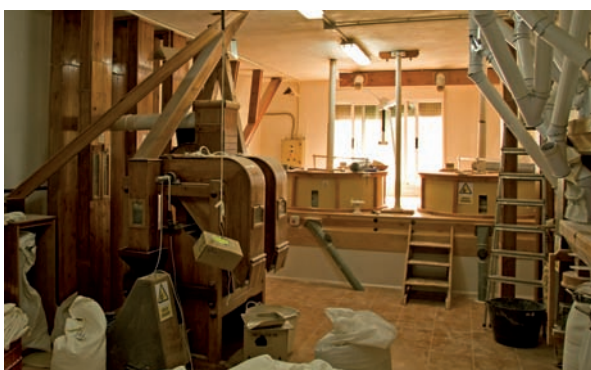
Accesorios para cribar el grano y a la derecha un verdadero "árbol" de tubos con sus correspondientes llaves de paso, para obtener diferentes mezclas de harina y salvado
