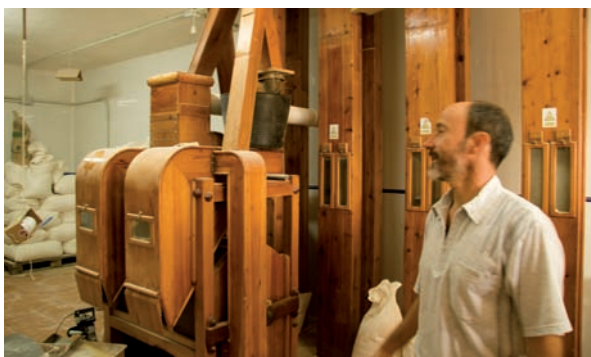
Todas las conducciones y maquinarias están revestidas de madera de pino y haya. Se puede ver parte de los elevadores que suben el grano al molino
